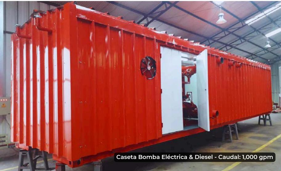
Caseta Bomba Eléctrica & Diesel - Caudal: 1,000 gpm
